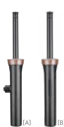
[A] PROS-06-SI-PRS30 [B] PROS-06-PRS30 Altura retraído: 22 cm Altura emergente: 15 cm Diámetro expuesto: 5,7 cm Conexión: 1/2"
