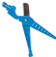
Herramienta múltiple para emisores Hunter P/N HEMT (Perfora orificios guía y gránulos, inserta y elimina emisores, corta tuberías)
