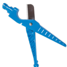
Hunter univerzális szerszám P/N HEMT (lyukaszt, behelyez és kiszed csepegtető testeket, csövet vág)
