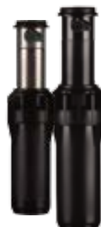
I-25-04 Hauteur totale : 20 cm Hauteur escamotable : 10 cm Diamètre exposé : 5 cm Taille de l'entrée : 1" BSP
