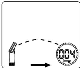
3. Nach einigen Sekunden werden die Segmente einer Strichlinie als Bestätigung der Funkübertragung zur WVC-Ventilsteuerung angezeigt. Wenn das letzte Segment angezeigt wird, ist die Datenübertragung abgeschlossen und das WVP-Programmiergerät gibt zwei Töne aus, um die erfolgreiche Übertragung zu bestätigen.
