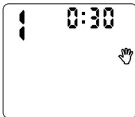
4. In der Betriebsart „Manuelle Bewässerung“ die Taste „Senden/Empfangen“ auf dem WVP-Programmiergerät betätigen und zwei Sekunden lang gedrückt halten, um die manuelle Bewässerung auszulösen.
