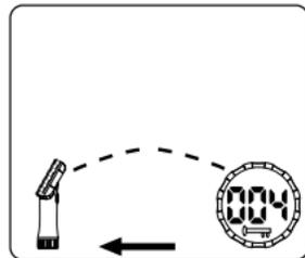
wird, ist die Datenübertragung abgeschlossen und das WVP-Programmiergerät gibt zwei Töne aus, um die erfolgreiche Übertragung zu bestätigen.
