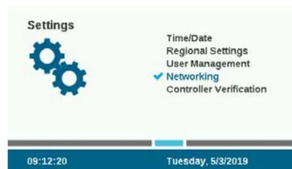
3. Pulse la tecla multifunción para abrir la configuración Wi-Fi. Si el módulo se va a usar para conectarse a un router inalámbrico, seleccione la casilla de verificación Network.
