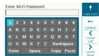
7. После ввода пароля с помощью поворотного переключателя выберите на клавиатуре кнопку Done («Готово») и нажмите на переключатель.
