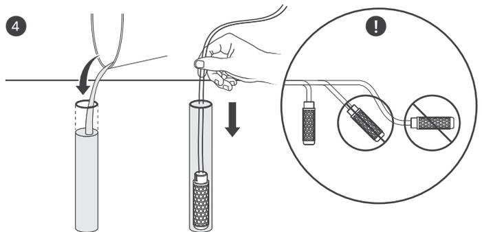
**!** Não instale a sonda na posição horizontal.
