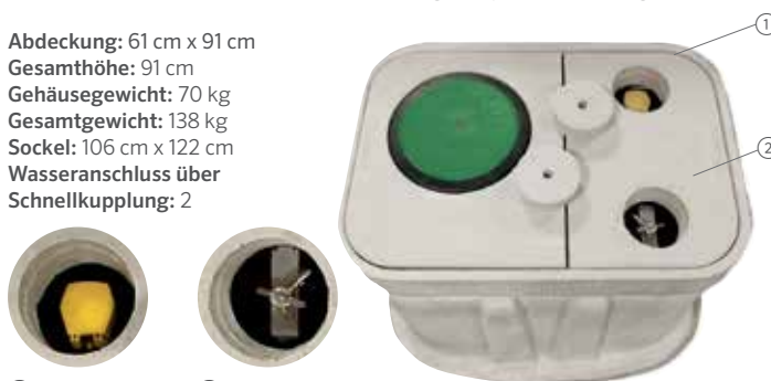
① Schnellkuppler ② Ein-Aus-Auto-Schalter
